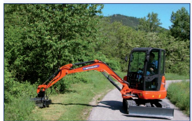
Dank einer Hilfshydraulikanlage ist es auch möglich, einen Häckslerkopf auf korrekte und funktionelle Weise einzusetzen.
