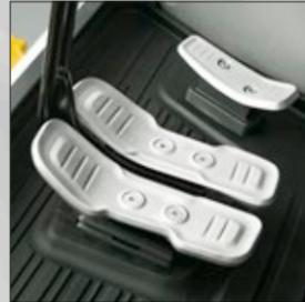
**Feinfühliges Bedienung** und exaktes Arbeiten mit hydraulisch vorgesteuerten Pedalen
