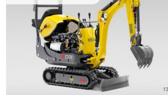
Leistungstärkster Antrieb seiner Klasse, kombiniert mit LUDV Hydrauliksystem für maximale Performance und präzise Steuerbarkeit, unabhängig von der zu bewegendem Last
