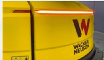
**Active Working Signal (AWS)** signalisiert umstehenden Personen, dass der Bagger in Betrieb ist
